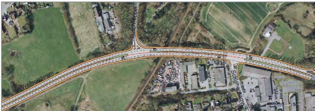
Abbildung 10-48: Planfall 3, Streckenführung, Querschnitt ausgebauter Wellseedamm (Abschnitt 3 und 4)
